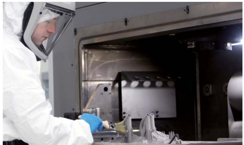
Bild 3: Eingesetzt wird bei ARNOLD das SLM-Verfahren (Selective Laser Melting), also das schichtweise Auftragen von Pulver und das partielle Verschweißen mit dem Laserstrahl. Verarbeitet werden dabei alle am Markt gängigen Werkstoffe.
